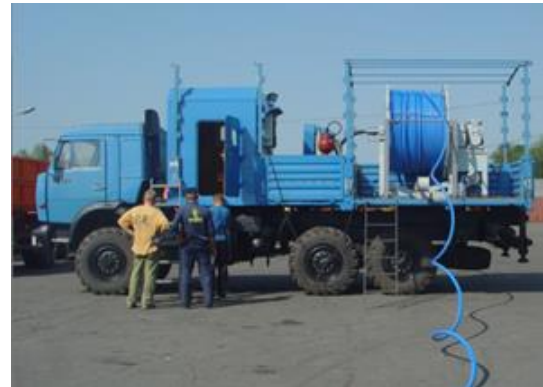
Рисунок 1 – Схема передвижной модульной установки кавитационного типа действия: 1 – буровой насос; 2 – барабан; 3 – рукав высокого давления; 4 – лебедка; 5 – электрический блок управления; 6 – червячный редуктор; 7 – домкраты.
